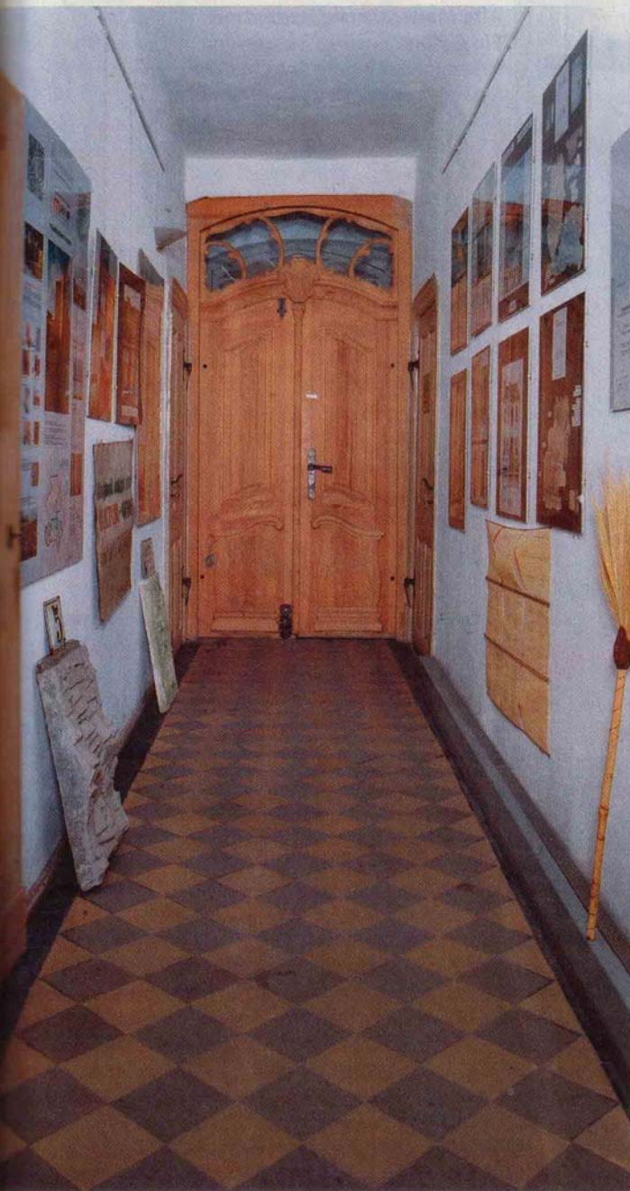
Der Eingangsflur dokumentiert mit Fotos und Fundstücken die Bau- und Sanierungsgeschichte des Hauses. Eine Wandheizleiste (rechts unten) wärmt Wand und Raum.
